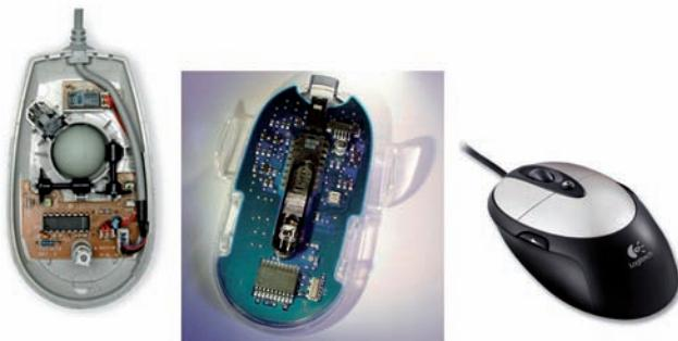
Slika 54. Mehanički i optički miš
